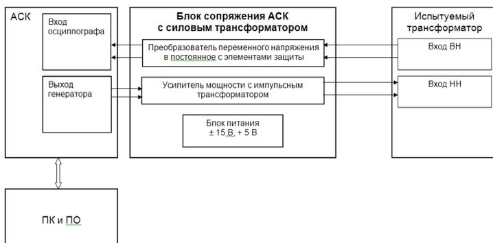
Рис. 2 – Структурная схема измерительного комплекса
