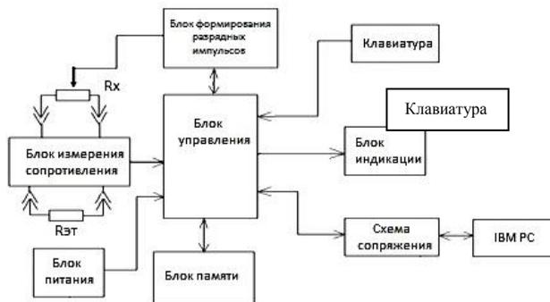
Рис. 1 – Функциональная схема автоматизированного комплекса
